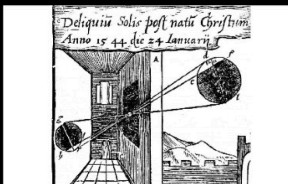
Cámara Oscura como herramienta astronómica. "De Radio Astronomica et Geometrica", Regnier Gemma, 1545.
