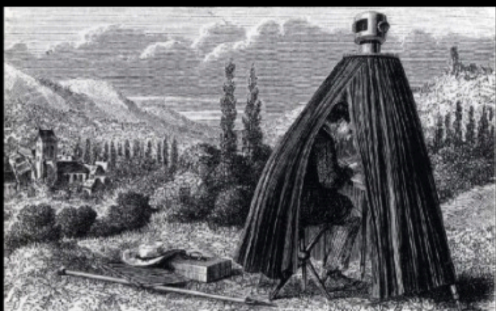
Cámara Oscura portátil de Kepler, para dibujar panorámicas y hacer mapeo topográfico. s.XVII.
